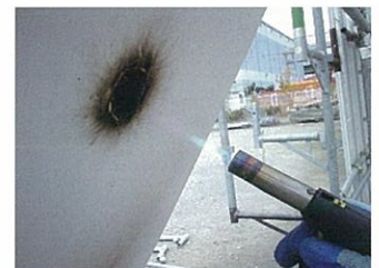
▲弊社にてガスバーナーで加熱し燃えないことを確認
